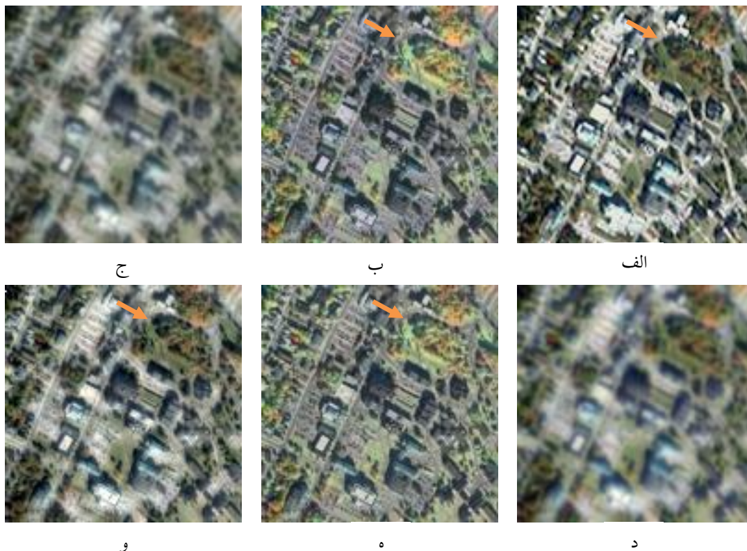
شکل ۲: نمایش RGB تصویر MS مرجع و تصاویر ادغام برای ماهواره IKONOS: الف) تصویر MS مرجع با وضوح مکانی ۱۶ متر، ب) روش IHS، ج) روش RIM، د) روش RIM-IHS، ه) روش JAIHS، و) روش پیشنهادی.
